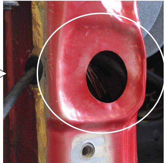
7.) Jetzt kann die originale Kabelbaumdurchführung mit Karosseriekleber und der beige-fügten Abdeckplatte abgedichtet werden.
