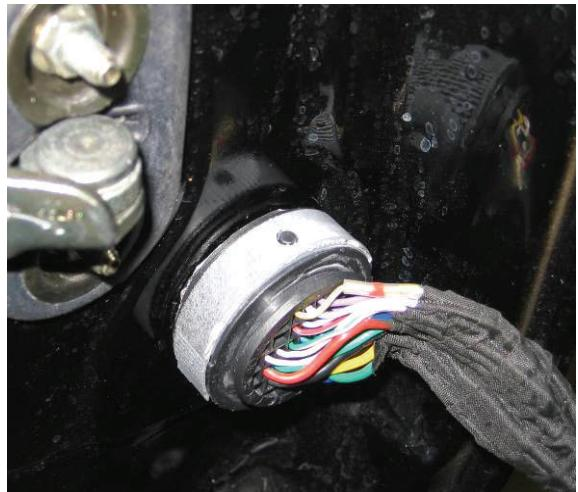
11.) Anschließend die Steckerverbindung mit dem mitgelieferten Karosseriekleber und Isolierband gegen Feuchtigkeit abdichten.
