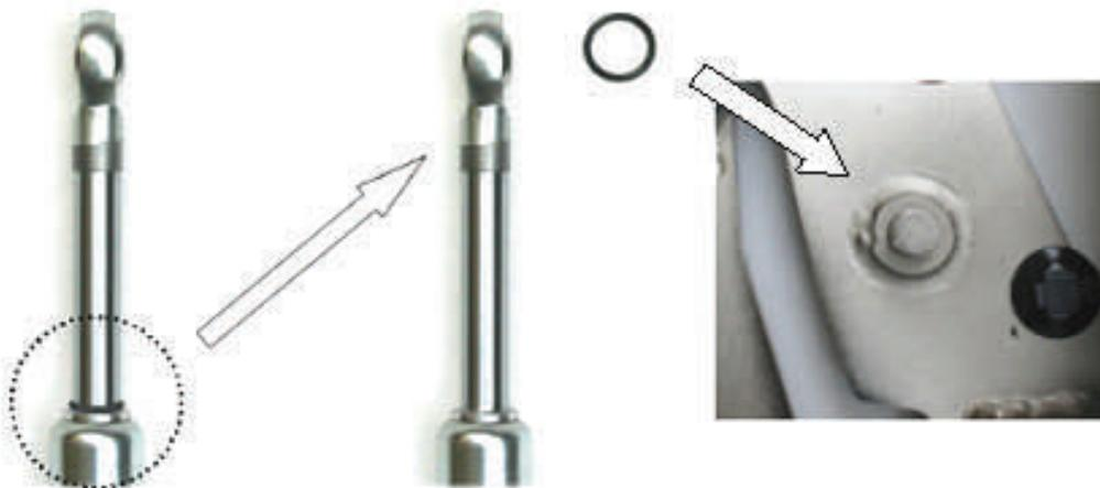
**Die Dämpferkennzeichnung muss sichtbar sein / The signification on the gas spring must be visible**
