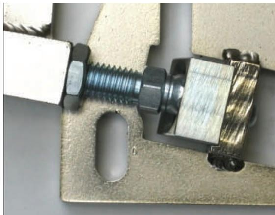
**TIPP:** Dabei den Kugelkopf der Einstellschraube (**1**) als Führungspunkt verwenden, um die Frontseite der Tür in die richtige Position zu führen.
