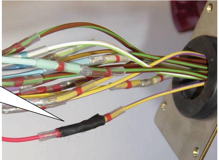
Am Schluss dann den kompletten Kabelbaum mit Hilfe des Gewebefbandes wieder ummanteln. Achtung: Kabel beim ummanteln gerade halten.
